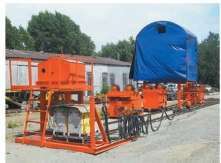
**Рис. 1. Полевая многофункциональная установка, модернизированная для сварки узлов трубопроводов габаритами до 22 м, массой до 25 т**
