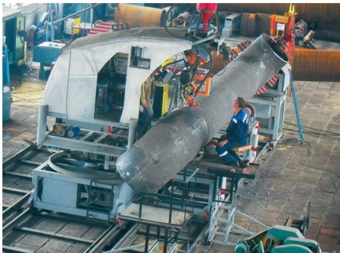
Рис. 2. Поточная линия для автоматической сварки трубных узлов
