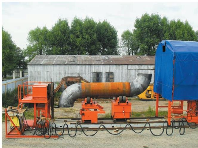
Рис. 3. Установка, позволяющая выполнять сварку не только крупногабаритных узлов, но и менее массивных коротких
